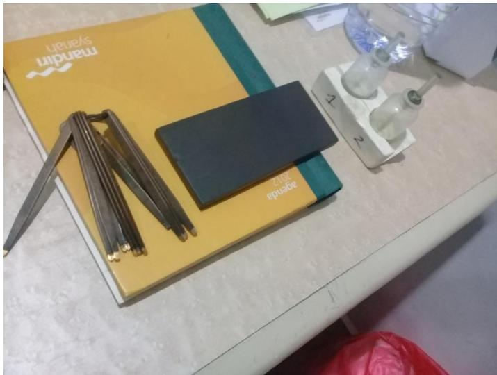
Alat untuk Menguji karatase Emas terdiri dari Air uji, Batu Uji, Jarum Uji
