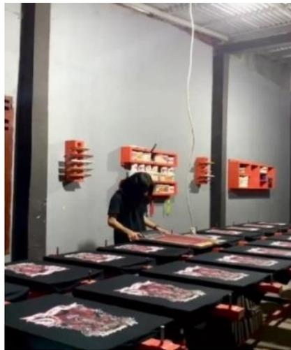
Gambar 4.5 Menempelkan film transfer ke bahan
