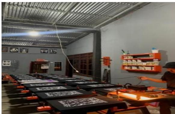
Gambar 4.6 Tahapan pengeringan tinta
